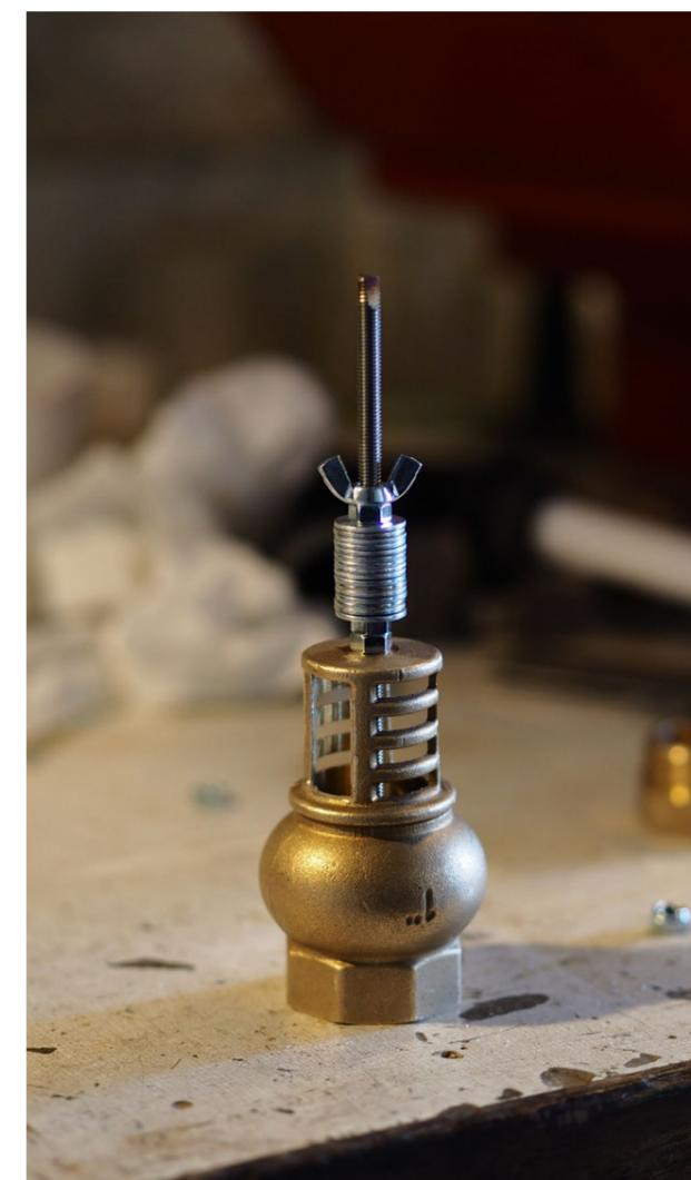
Détail du clapet de choc réalisé
