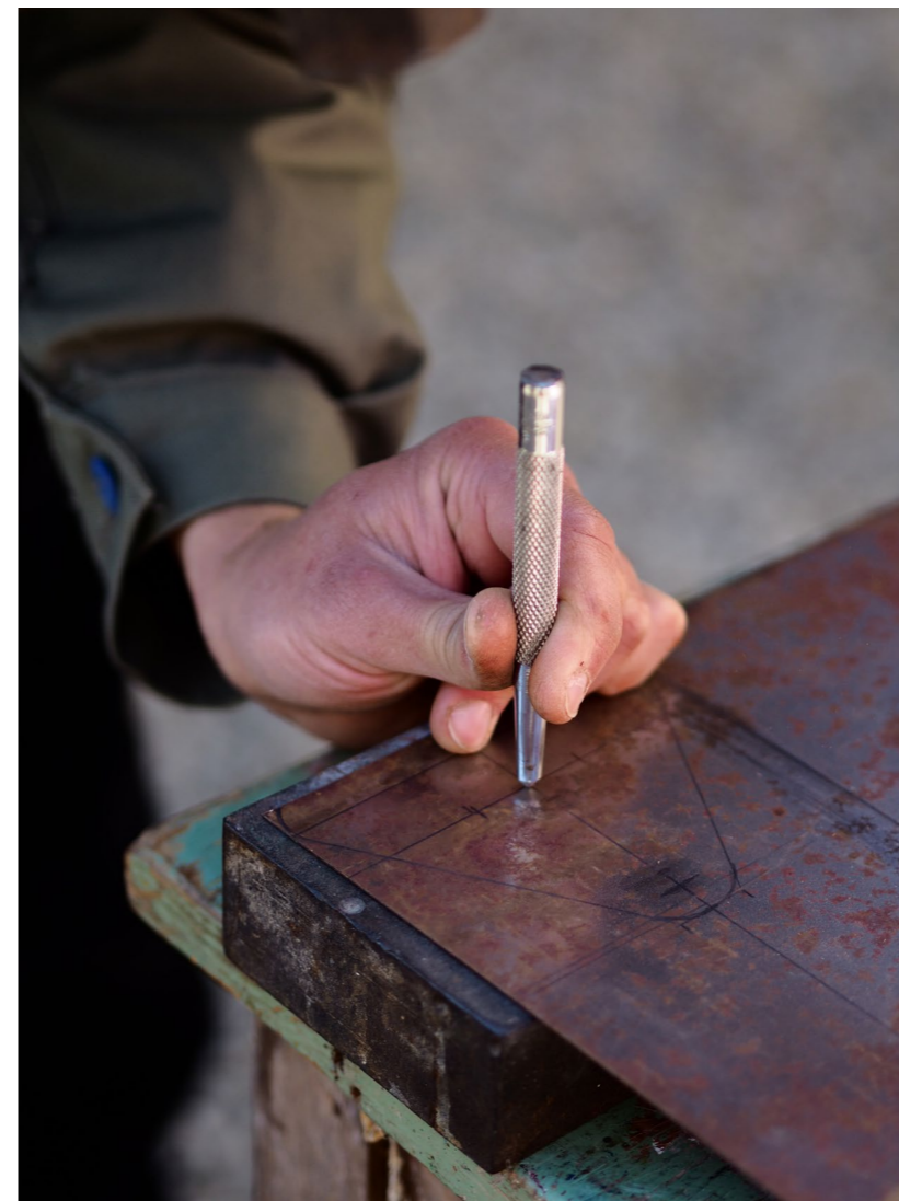
Traçage et poinçonnage de la tôle
